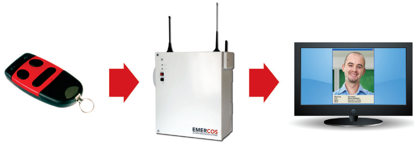
Schematische Darstellung der Visualisierung mit den EMERCOS Komponenten: Handsender, Alarmzentrale, Computer im Rektorat
